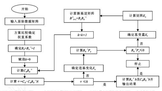
$B_0$  为初始的基变量组成的矩阵; $B_0^{-1}$ 为初始基变量矩阵的逆矩阵; $C_B$  为基变量中的系数组成的矩阵;k 为迭代的次数; $B_K^{-1}$ 为第 k 次迭代的基变量矩阵的逆矩阵;I 为单位矩阵; $C_N$  为非基变量中的系数组成的矩阵;N 为非基变量组成的矩阵; $P_q$ ,  $E_L$  为单位列矩阵,用于矩阵变换; 为检验数; $B_k^{-1}$ 为第 k+1 次迭代的基变量矩阵的逆矩阵;D 为常数项组成的矩阵
