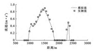
图 4 入黄口上游断面流速模拟结果
