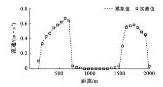
图 5 入黄口下游断面流速模拟结果
