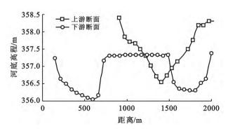
图 1 入黄口上游和下游两断面河底高程分布
