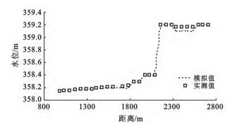
图 2 入黄口上游断面水位模拟结果
