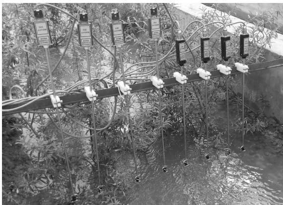
图 2 ZLY-I 型智能流速仪
