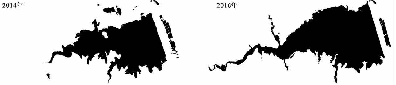
图 5 利用纹理特征波段合成并进行 ISO 提取的水体
