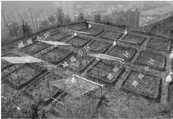
接高低两端的横向钢架与水平面呈 20° 夹角。遮雨结构:遮雨材料为 V 形槽,采用透光率超高的有机玻璃作为遮雨棚的主要材料,将有机玻璃板做成长条 V 形槽,呈栅格状形式排列在不锈钢制框架上,并用螺丝将其固定。根据遮雨量不同,设置不同 V 形槽数量,即-20%降水量小区架设 6 个 V 形槽;-40%降水量小区架设 12 个 V 形槽;-60%降水量小区架设 18 个 V 形槽。集雨结构:将大圆形 PVC 管侧面设置矩形切口,将遮雨结构的 V 形槽管末端插入切口,再通过 PVC 管引流到带有刻度的圆桶。雨后将不同降水梯度水桶里的雨水用小型抽水泵均匀地洒入对应的增加降水小区。每个处理随机分布设置了 3 个重复小区,共 21 个试验小区,小区面积为 3 m×3 m,各小区间设置 2 m 的缓冲带(见图 1)。
