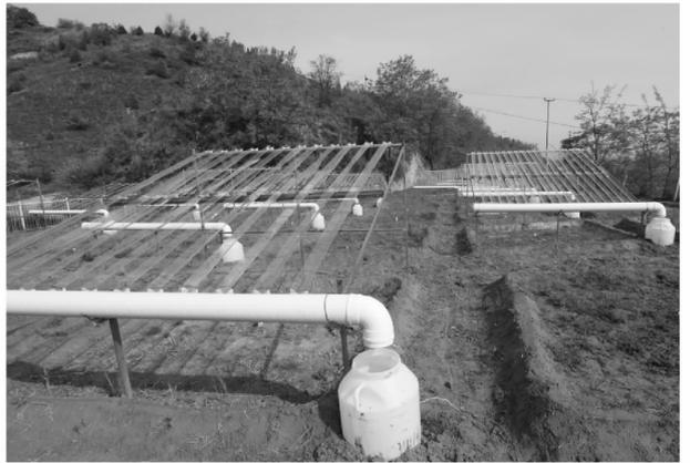
图 1 试验小区布置(左)和人工模拟降水设施布置(右)
