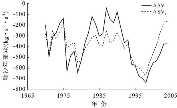
图 1 温家川站实际泥沙年变异  $\Delta SV$  与计算泥沙年变异  $\Delta SV_c$  时间过程比较
