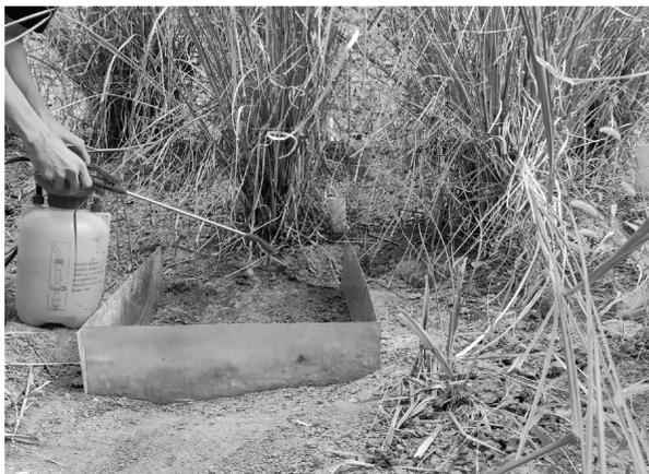
图2 香根草植物边坡模拟降雨试验
