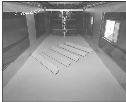
图 3 光伏阵列与风向不同夹角( \alpha )风洞模拟试验布设示意图
