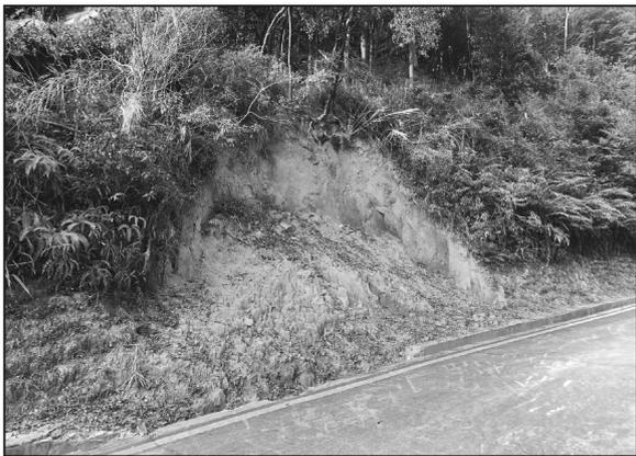
图2 滑移式崩塌
