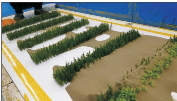
图 9 8 m/s 风速条件下配置防护林阻沙特征
