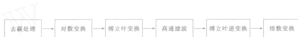
图 3 基于 Erdas 软件的去云步骤
