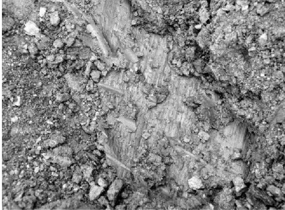
图4 边坡的泥化滑动面及擦痕
