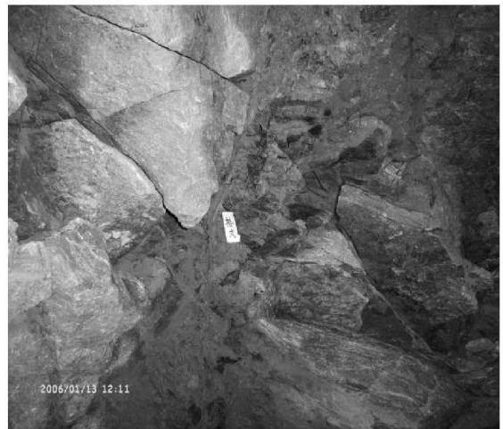
b 结构面中填充的来自浅部土壤层的黏土
