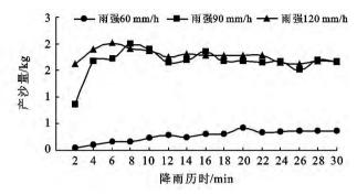
图 1 3 场模拟降雨试验产流量及产沙量随时间变化
