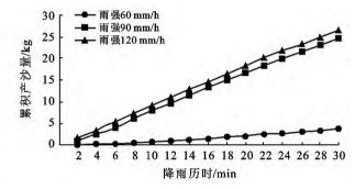
图 2 3 场模拟降雨试验累积产流量及产沙量随时间变化
