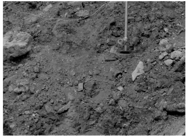
图 9 现场经 SH 固化后的土堆表面形态
