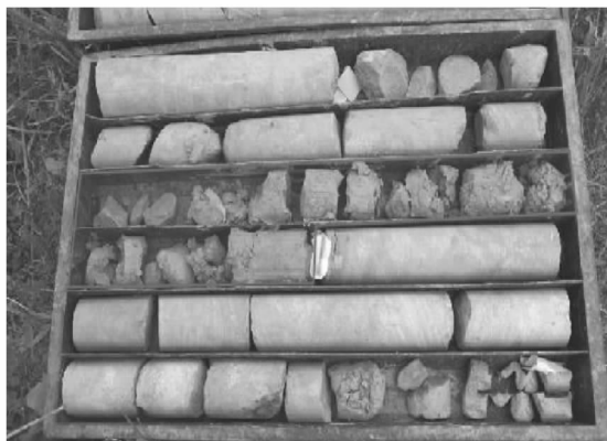
图 2 钻孔揭露的原状滑带土
