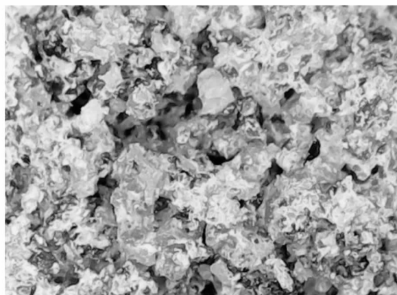
图 9 冻融循环 10 次试样断面形貌特征
