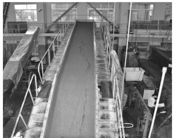
b 降雨试验系统装置
