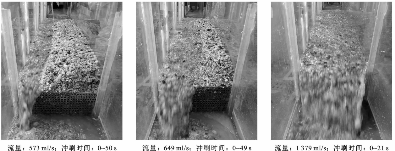
图3 不同流量条件固体物质冲刷过程正视图
