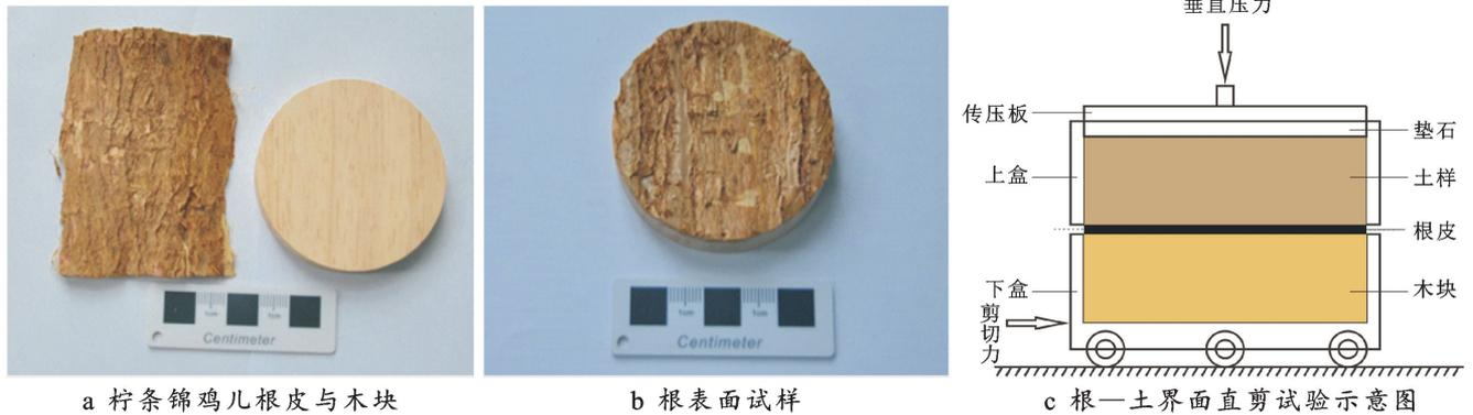
图 1 柠条锦鸡儿根—土界面直剪试验过程
